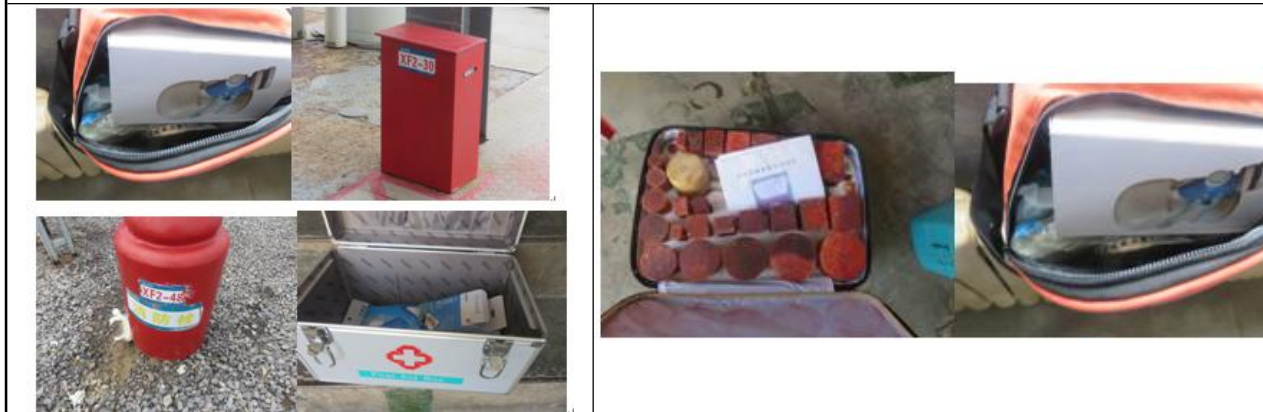
防毒面具、滤毒罐、手提式灭火器、室外消防栓、应急药箱
